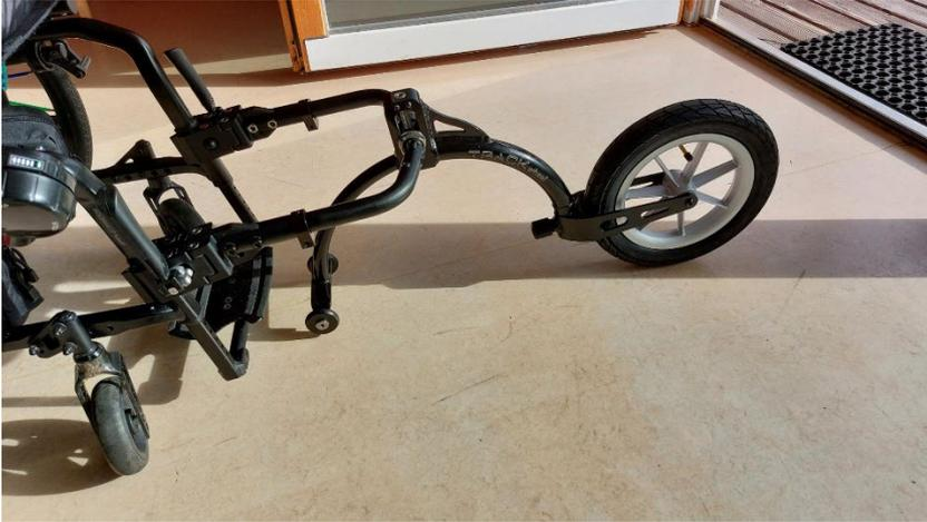
2. Die Klemmen am Rollstuhl fixieren und gut schließen. Die kleinen Stützräder sollten Bodenkontakt haben. Ist dies nicht der Fall kann die Höhe geändert werden.
